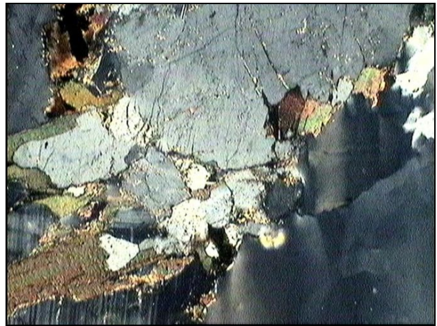
Рис. 13. Характер мікродеформацій в біотитових плагіогранітах (пункт 1-1). Тут і далі на фото шліфів розмір довгої сторони кадрів 1,43 мм; ніколи схрещені.
